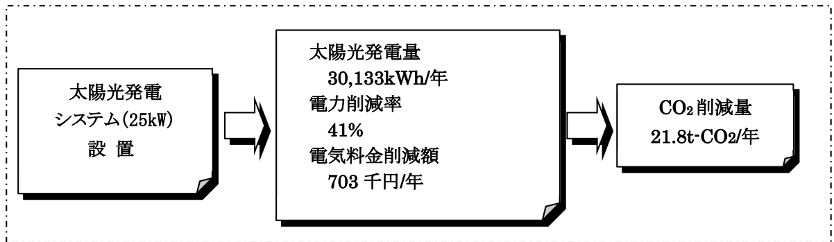
図表 7-23 やすらぎの里けんこう館への太陽光発電システムの導入効果：25kW
